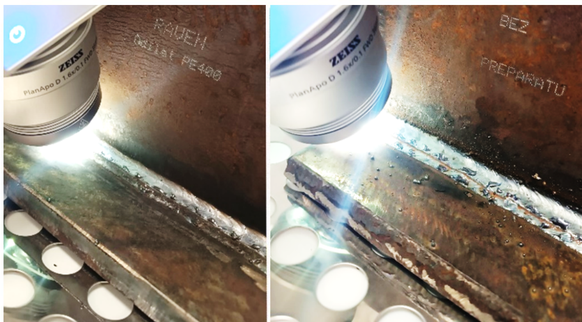
Rys. 5. Spoina pachwinowa wykonana metodą 136 bez (a) i po wcześniejszym naniesieniu separatora Odilat PE400 (b)
