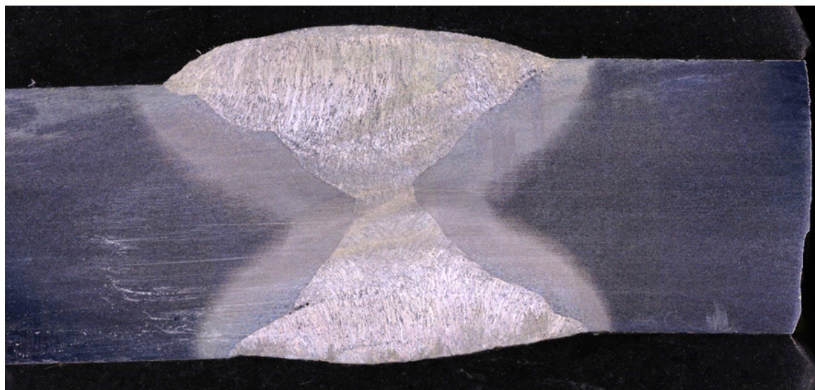
Rys. 6. Przykład zglądu porzecznego połączeń spawanych z naniesieniem separatora Odilat PE400
